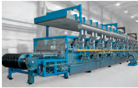
Bild 3a, 3b, 3c: Durchlaufofen mit BSN-Hubschrittförderer, welcher für das Austenitisieren und Erwärmen von hochfesten Karosseriebauteilen auf Presshärte-Temperatur eingesetzt wird
