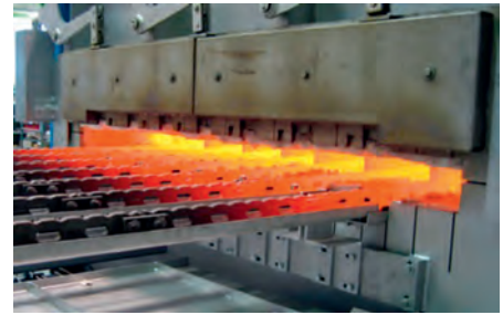
Bild 3a, 3b, 3c: Durchlaufofen mit BSN-Hubschrittförderer, welcher für das Austenitisieren und Erwärmen von hochfesten Karosseriebauteilen auf Presshärte-Temperatur eingesetzt wird
