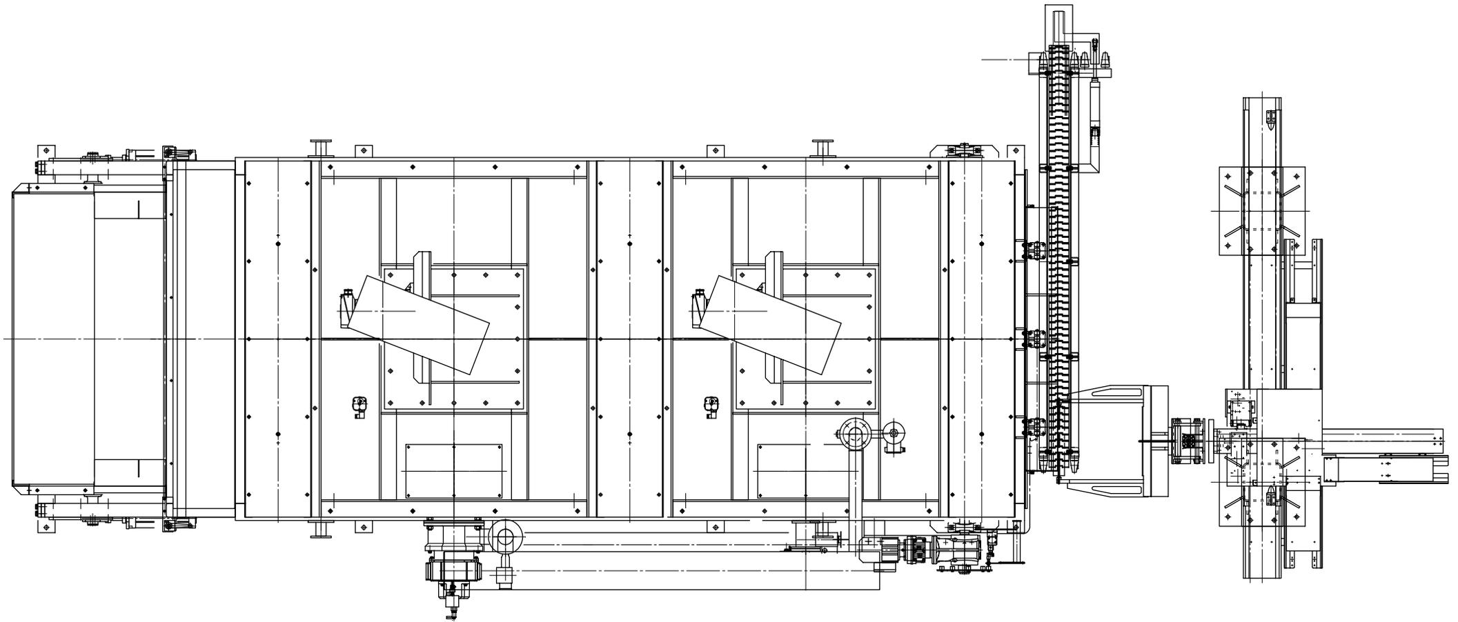
Layout eines Kettendurchlaufofens zum Erwärmen von Alu-Schmiedeteilen mit Jet-Heating einschließlich automatischer Entnahme mit Transfer zur Presse.
